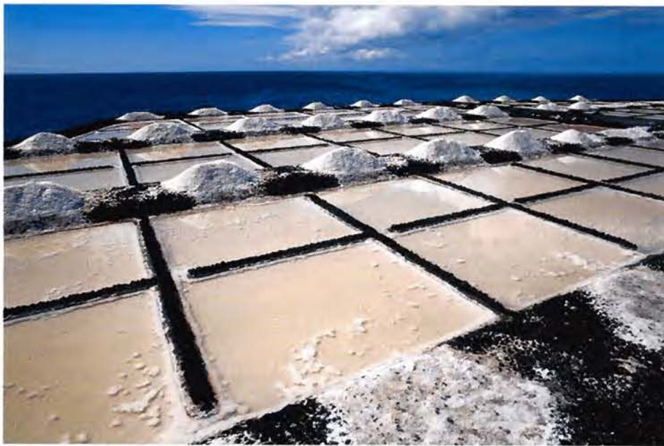
Während des Verdunstungsprozesses durchläuft das Meerwasser mehrere Kilometer Weg durch das Salinensystem. Während dieser Zeit verdunstet neunzig Prozent des Wassers. Hier bei Punta da Fuencaliente auf der Kanareninsel La Palma wird das kristallisierte Salz aus den Becken entfernt und zu kleinen Haufen aufgeschichtet. Foto Laszlo Fekete
